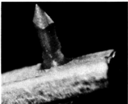
12b Abtastnadel des Goldring G 900 SE, Verrundungsradien  $5/18 \mu$ , elliptischer Schliff, auffallend langer, nackt montierter ganzer Stein
